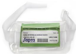
**Composição dos monitores:** O modelo convencional é composto pelo case contendo filtros de plástico e metal (alumínio e cobre) e um slide [3] contendo um conjunto de quatro sensores de óxido de alumínio crescido em atmosfera de carbono ( $Al_2O_3 - C$ ). Para proteção, os dosímetros são selados em uma bolsa plástica à prova d'água [1]
